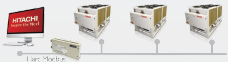
Estes equipamentos são completamente automatizados, por meio de placas microprocessadas que comandam o funcionamento dos equipamentos de forma a obter o melhor rendimento. Agora a interação com um supervisor com protocolo Modbus(BSM) pode ser feita de forma bem simples e economica, por meio de uma HARCMODBUS.
